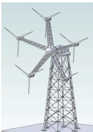
Obr. 1.11 Mriežková veža s výkonom 12 MW [16]
