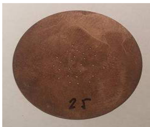
Obr. 4.3: (a) Fraunhoferova difrakce na 25 náhodně rozmístěných otvorech, (b) difrakční maska. Poloměr masky R = 1.5 cm, poloměr oblasti ve které byly rozmístěny otvory R' = 0.6 cm, poloměr každého kruhového otvoru r = 0.15 mm.
