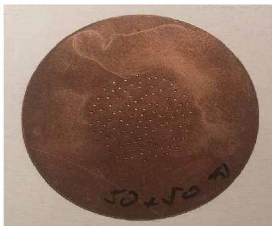
Obr. 4.4: (a) Fraunhoferova difrakce na 50 náhodně rozmístěných symetrických dvojicích otvorů, (b) difrakční maska. Poloměr masky R = 1.5 cm, poloměr oblasti ve které byly rozmístěny otvory R' = 0.7 cm, poloměr každého kruhového otvoru r = 0.15 mm.
