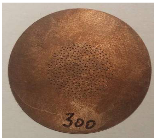
Obr. 4.6: (a) Fraunhoferova difrakce na 300 náhodně rozmístěných otvorech, (b) difrakční maska. Poloměr masky R = 1.5 cm, poloměr oblasti ve které byly rozmístěny otvory R' = 0.7 cm, poloměr každého kruhového otvoru r = 0.15 mm.
