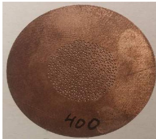
Obr. 4.7: (a) Fraunhoferova difrakce na 400 náhodně rozmístěných otvorech, (b) difrakční maska. Poloměr masky R = 1.5 cm, poloměr oblasti ve které byly rozmístěny otvory R' = 0.7 cm, poloměr každého kruhového otvoru r = 0.15 mm.
