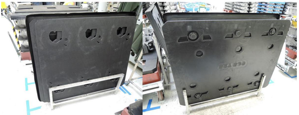
Obrázek 21 Přípravek na zakládání prokladů
