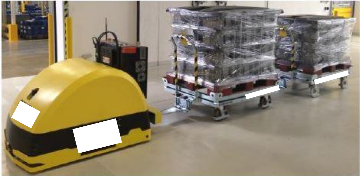
Obrázek 16 Autonomní tahač FTS s paletami skříní [10]
