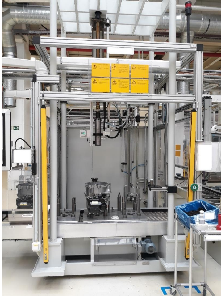
Obrázek 39 Stanice lisování těsnícího kroužku hnací hřídele
