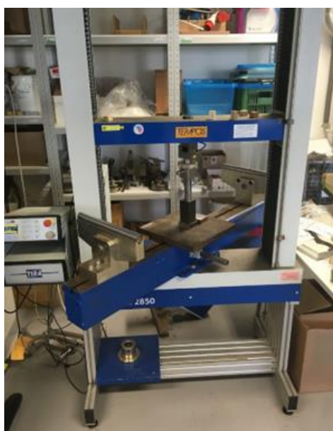
Obrázek 9 Tira test sloužící k výrobě pelet
