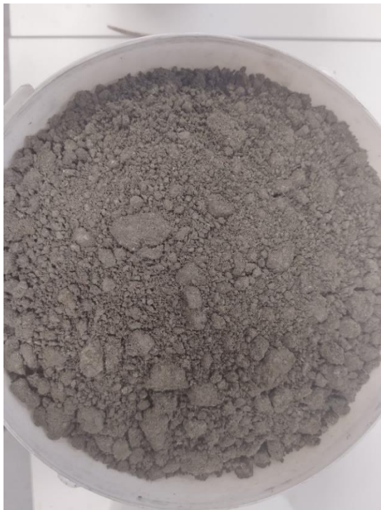
Obrázek 5 Mletá směs při 50 kg/h
