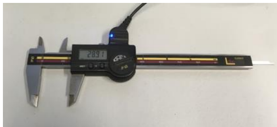
Obrázek 12 Posuvné měřítko sloužící ke zjištění rozměrů pelet
