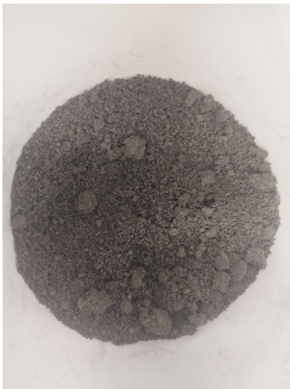
Obrázek 7 Mletá směs při 150 kg/h
