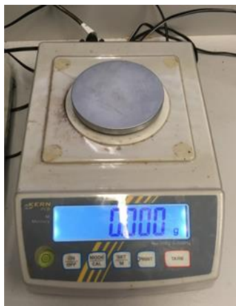
Obrázek 8 Laboratorní váha IPC sloužící k navázení směsi
