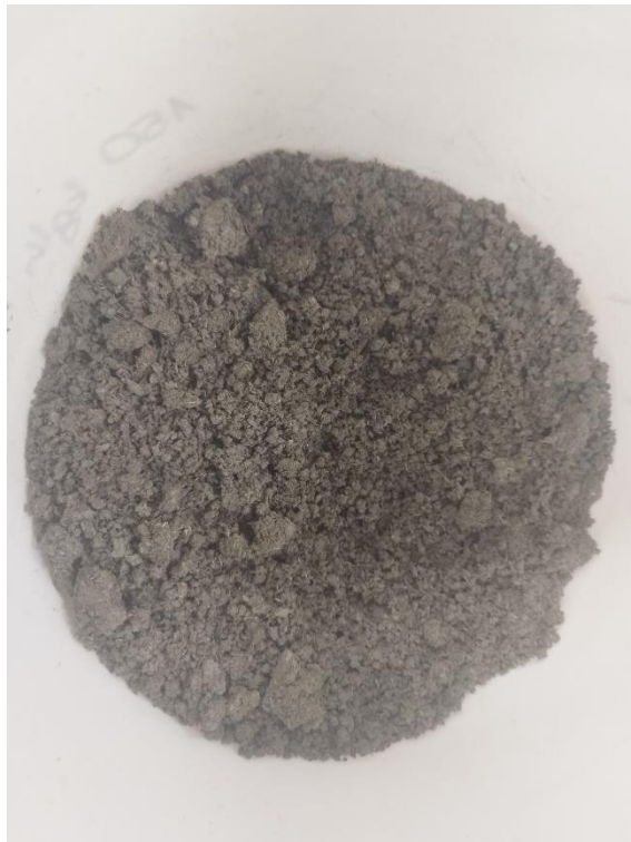
Obrázek 4 Mletá směs při 25 kg/h
