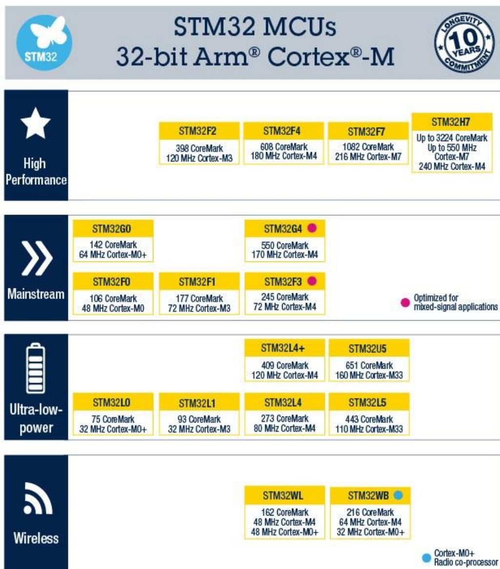
Obr. 8: Skupiny mikrokontrolérů platformy STM32 [20]
