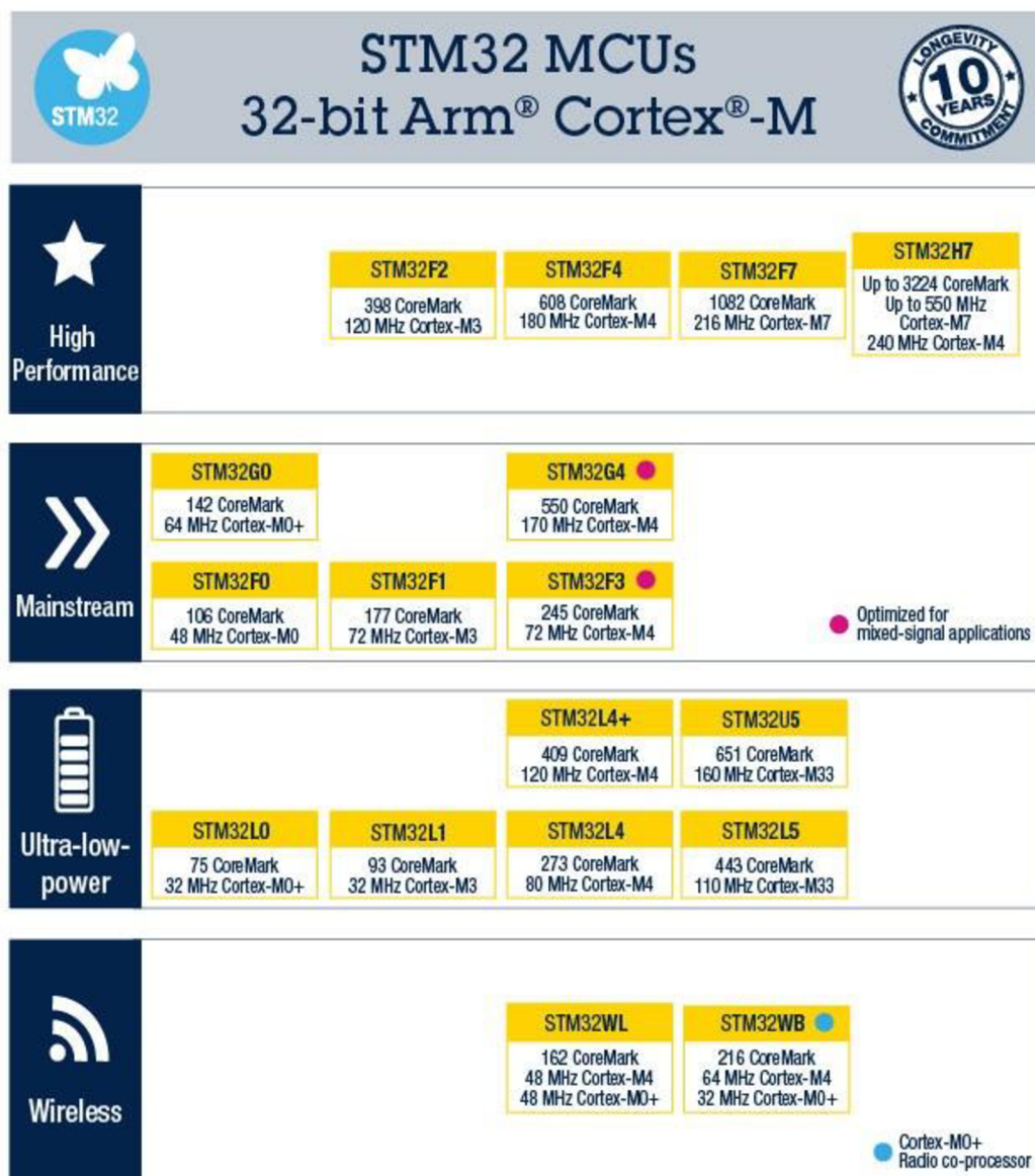
Obr. 8: Skupiny mikrokontrolérů platformy STM32 [20]
