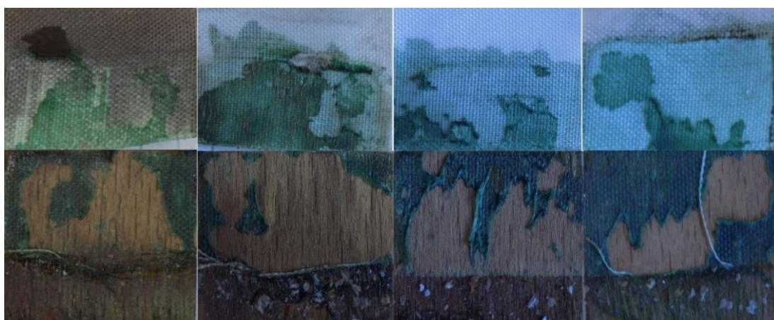
Obr. 37. Adhezní porušení překližkových vzorků (zleva: 5. až 8. týden)
