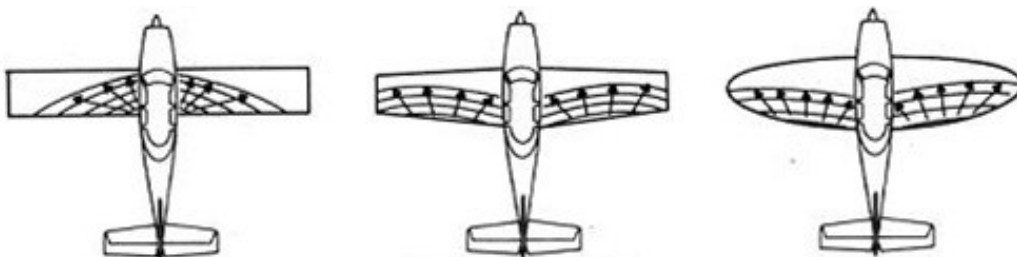
Obrázok 5.2 - Obdĺžnikový, lichobežníkový a eliptický tvar krídla a ich odtrhávanie prúdu [42]
