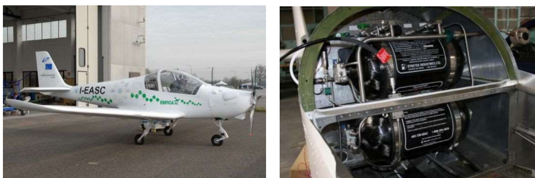
Obrázok 3.6 -Modifikované ultralohké lietadlo Rapid 200FC a uskladnenie vodíka na palube [17],[18]
