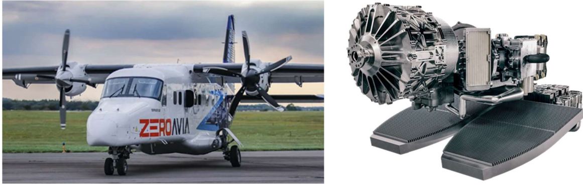
Obrázok 3.9 - Modifikovaný Dornier 228 a pohonná jednotka ZA600 na vodík [22],[23]
