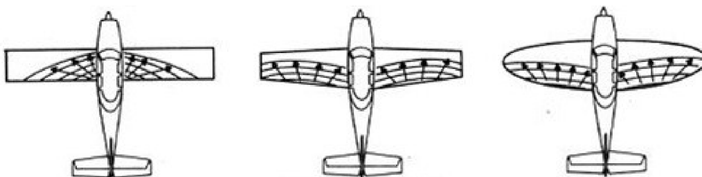
Obrázok 5.2 - Obdĺžnikový, lichobežníkový a eliptický tvar krídla a ich odtrhávanie prúdu [42]
