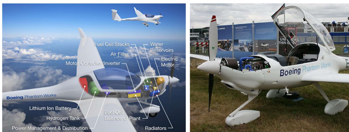
Obrázok 3.3 - Modifikovaný motorový vetroň Dimona na čiastočný vodíkový pohon [13],[14]
