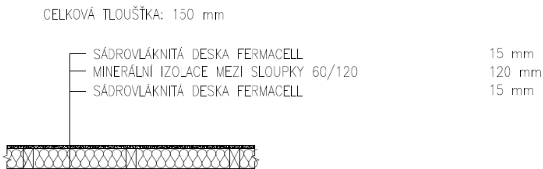
Obr. 10: Skladba vnitřní nosné stěny
