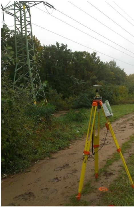
Obr. 15 - Měření pod el. vedením
