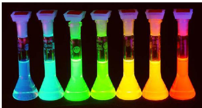
Obr. 2 Příklad fotoluminiscence u kvantových teček. [9]
