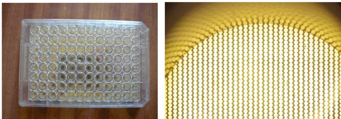
Obr.19 Zlaté elektrody, vlevo sensorové pole elektrod, vpravo detail hřebínků elektrod
