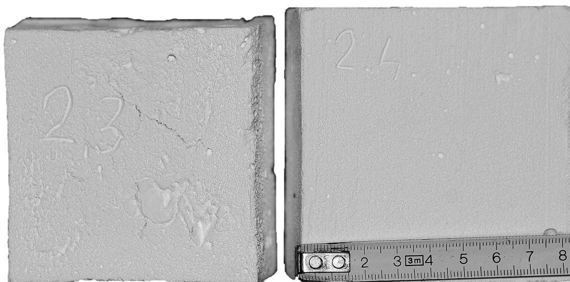
Obr. 3.25: Vhled trhlin na vzorcích: vlevo 3.3, vpravo 3.4
