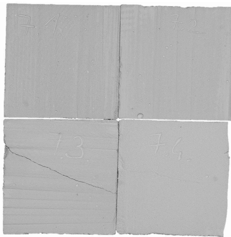
Obr. 4.37: Výskyt trhlin v ŽB s obsahem Al 2 O 3 po tuhnutí pojiva
