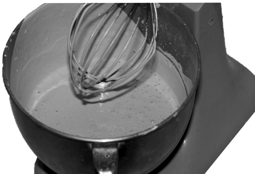
Obr. 4.45: Typ míchadla při in-situ napěňování kaolinového ZB tenzidem SCHM
