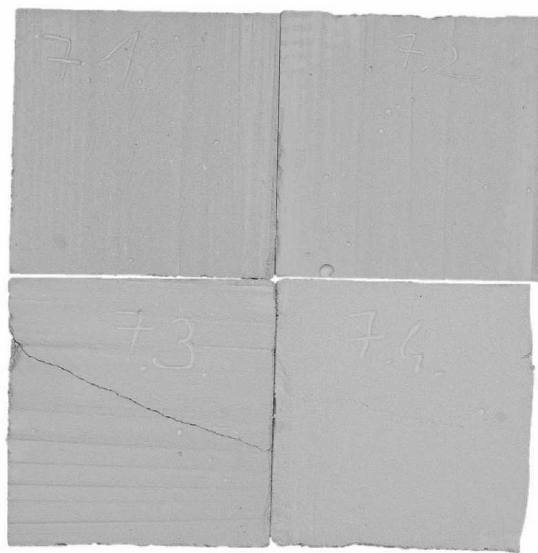
Obr. 4.37: Výskyt trhlin v ŽB s obsahem Al 2 O 3 po tunutí pojiva
