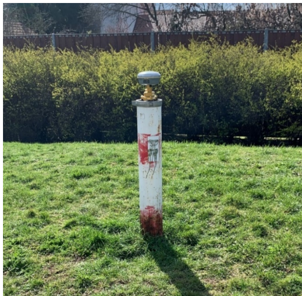
obr.11: Přijímač Trimble R8s na bodě 102. [zdroj: Autor]
