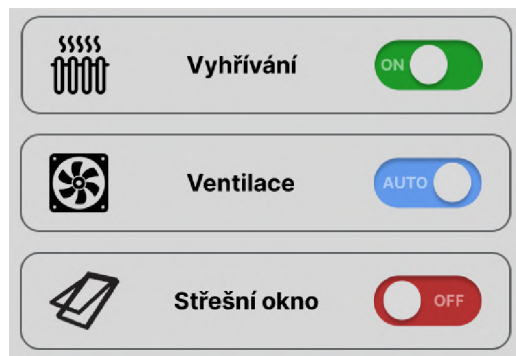
(b) Řízení aktuátorů pomocí třístavových přepínačů.
