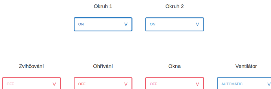
Obrázek 2.4: Aktuátory se v řešení firmy Sensorie nastavují pomocí dropdown nabídek. V nich lze vybrat prvně automatický režim, jenž ponechá řízení na automatickém algoritmu, nebo vybraný aktuátor rovnou vypnout či zapnout.
