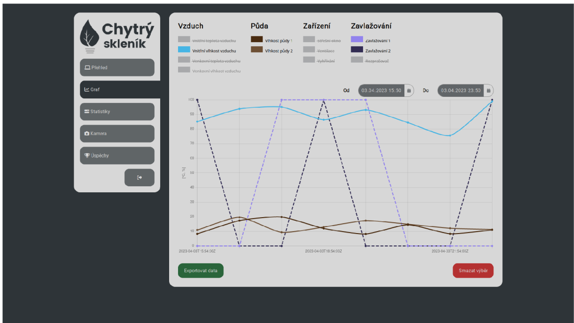
Obrázek B.6: Graf. Ukázka analýzy změn zavlažování na vlhkosti vzduchu i půdy.
