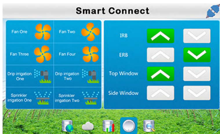
Obrázek 2.7: Mobilní aplikace má separovanou sekci pro řízení podmínek. Otevírání oken a manipulace se žaluziemi, které zajišťují korekci slunečního svitu vnikajícího do skleníku, se provádí pomocí šipek v pravé části rozhraní. Doplnění vláhy zde zajišťuje postřikovač a kapkové zavlažování. Pro korekci teploty v systému slouží chladicí podložky a ohříváč vzduchu. Dodávají také dodatečný světelný zdroj a ventilátory.
