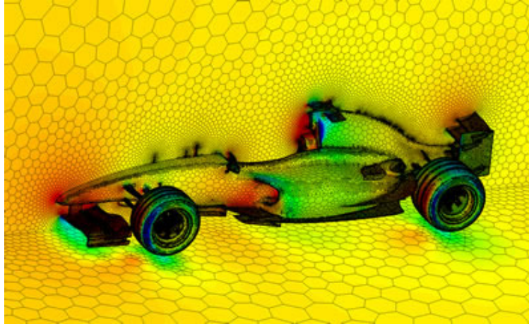
Obr. 25: Síť z mnohostěnů a rozložení tlaků na formuli F1 pro post-procesing s použitím programu ANSYS CFD-Post.[33]
