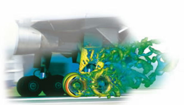
Obr. 21: Vírové struktury generované koly přistávacího letadla.[33]
