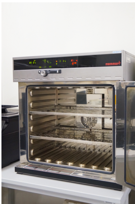
Obrázek 4 Laboratorní sušárna MEMMERT UFE 500
