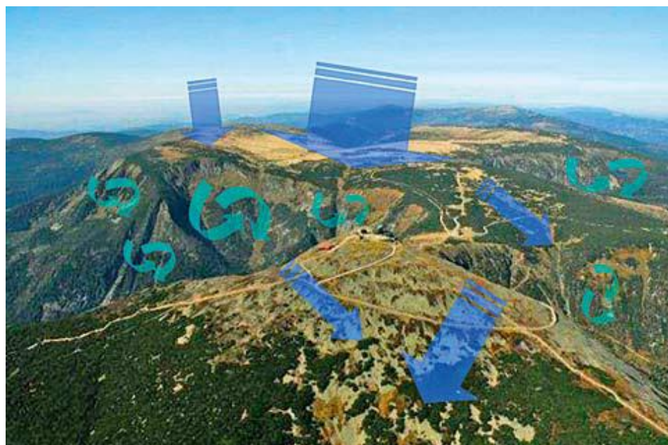
Obr. 18 - Pohled od východu a schéma aerodynamiky v širším obvodu náhorní planiny východních Krkonoš, okolních karů a Sněžky (vpředu); tmavěmodré šipky naznačují směr laminárního proudění od západu, světle modré šipky představují závětrný prostor s turbulentním prouděním
