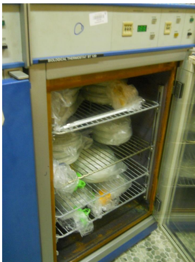
Obrázek 16 Ukázka termostatického boxu, ve kterém semena klíčila
