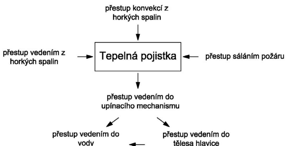
Obr. 20 – Schéma tepelné výměny ve sprinklerové hlavici (22)
