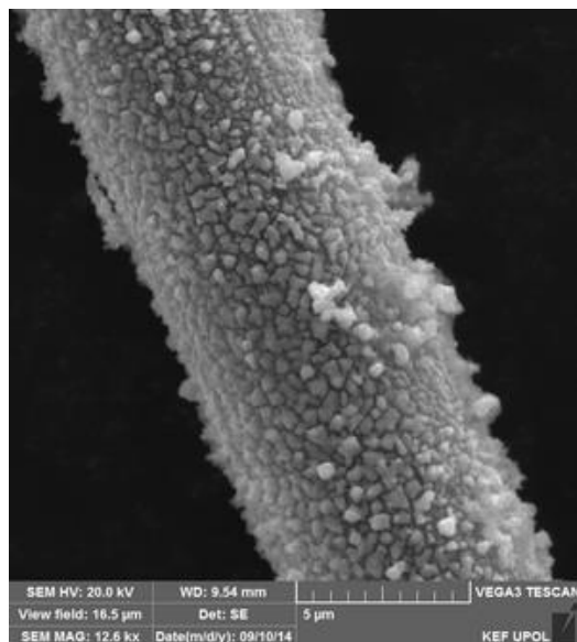
Obr. 40: Snímek (SEM) cínové vrstvy deponované na CFE při 30 V a 30 min, G = 0,14 \mu\text{S}
