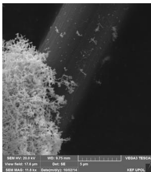
Obr. 14: Snímek (SEM) stříbrné vrstvy deponované na CFE při 30 V a 30 min, G = 0,18 \mu\text{S} , ukázka odlupování robustní stříbrné vrstvy
