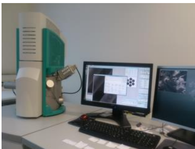
Obr. 5: Skenovací elektronový mikroskop (Tescan Vega3)
