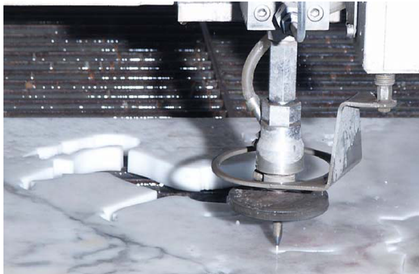
Obr. 1 Detail řezací hlavy při hydroabrazivním řezání (7)
