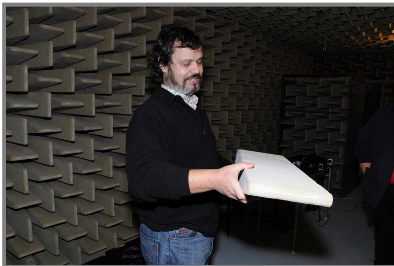
Obr. 8 Akustické obložení bezdozvukové komory v Ostravě
