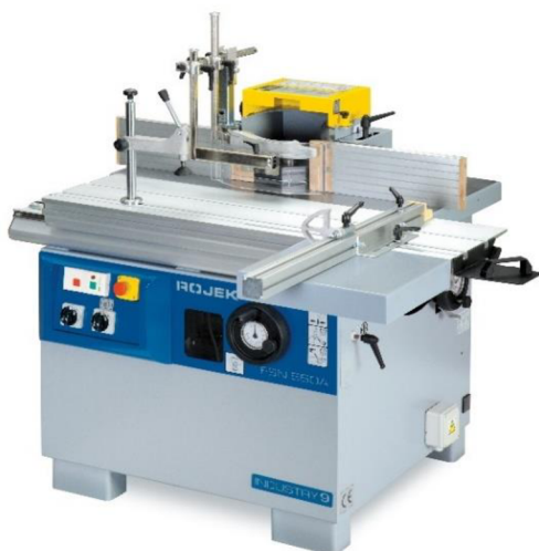
Obr. 10 Spodní svislá frézka [19].
