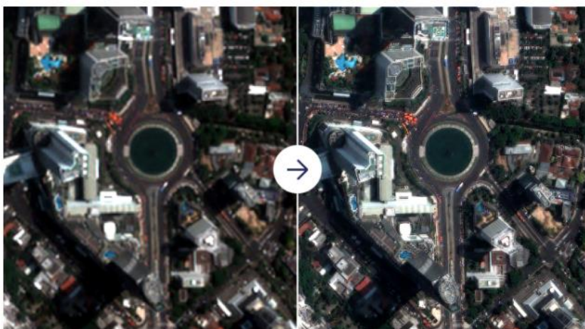
Obrázok 7 Snímok pred (vľavo) a po (vpravo) pansharpeningu. (zdroj: https://up42.com/blog/how-pansharpening-improves-satellite-imagery )
