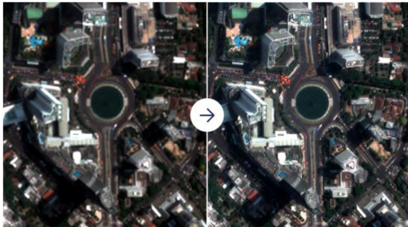
Obrázok 7 Snímok pred (vľavo) a po (vpravo) pansharpeningu. (zdroj: https://up42.com/blog/how-pansharpening-improves-satellite-imagery )
