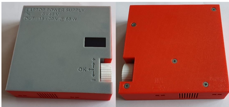
Obrázok 8.3 Zariadenie umiestnené v navrhnutom puzdre
