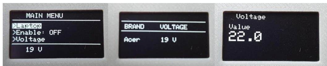
Obrázok 7.2 Zobrazované menu a jeho položky, zľava: hlavné menu, voľba značky laptopu, nastavenie požadovaného napätia
