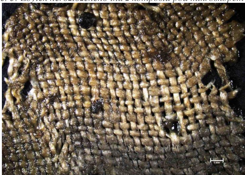
Obr. č. 3: Zbytek nerozloženého lnu z kompostu pod mikroskopem (6,3x)
