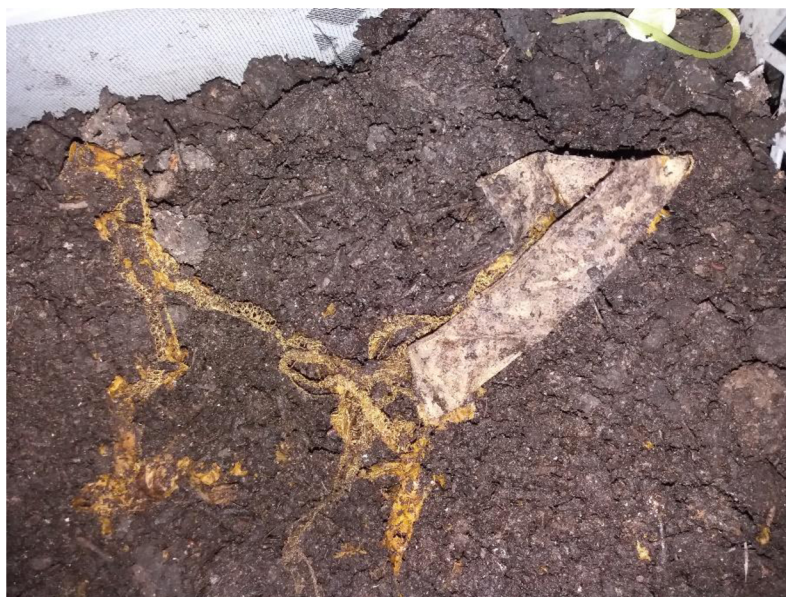
Obr. č. 6: Nerozložené části viskózové látky v kompostu
