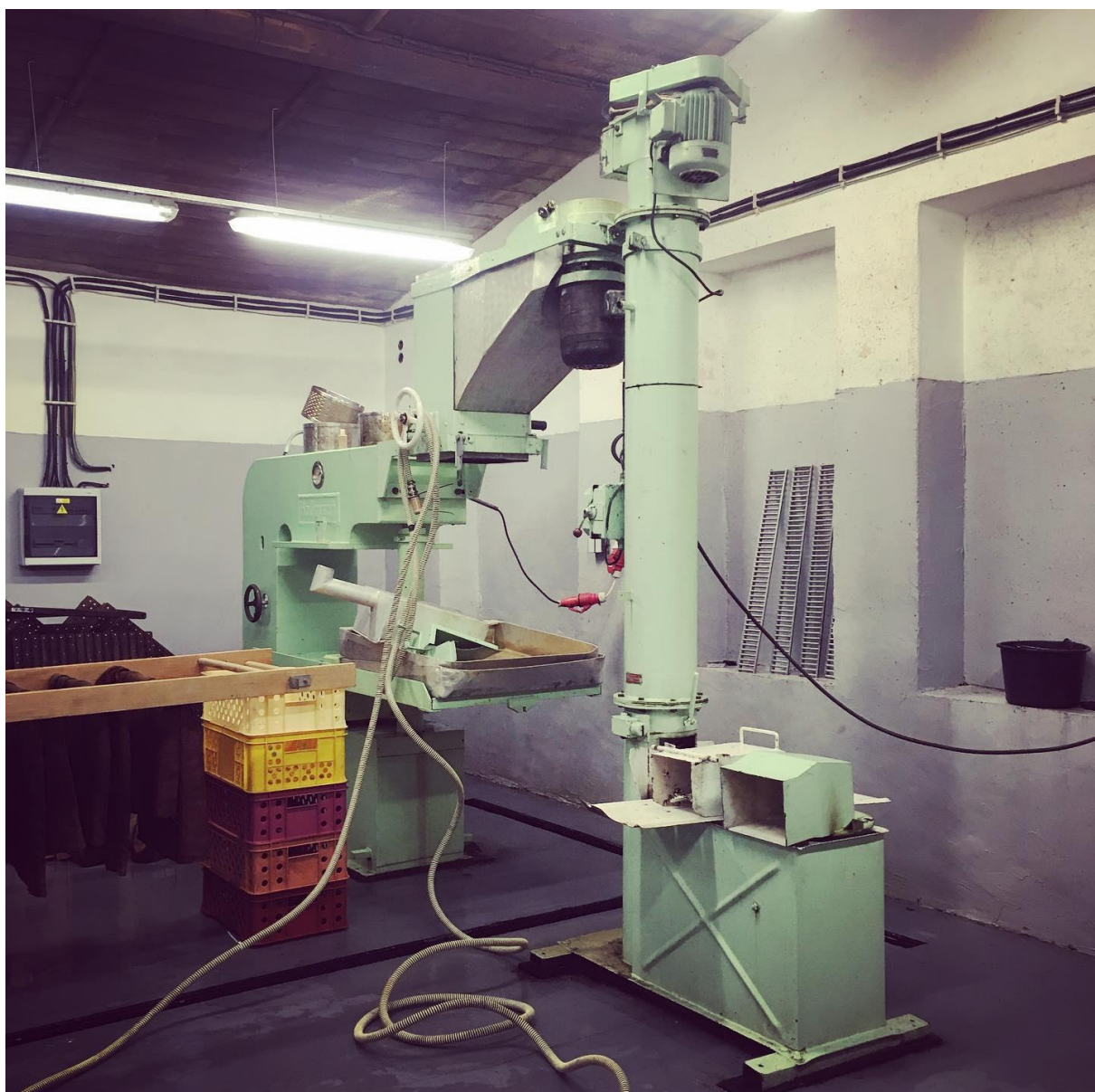
Příloha 4: Drtící a lisovací linka Hollman (1957) společnosti Cidérka Lobeč s.r.o. (zdroj: https://www.facebook.com/photo/?fbid=3050312631901390&set=pb.100057235275289.-2207520000 )
