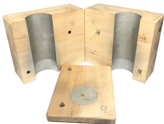
Obr. 61 Rozebraná dřevěná část jaderníku.
