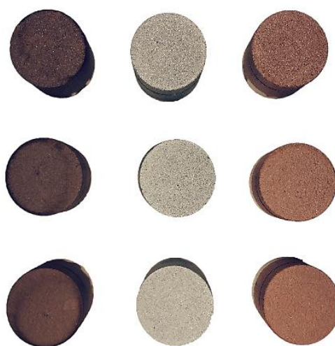
Obr. 89 Jedna sada vzorků (ze tří) k měření prodyšnosti. V sadě jsou pro každý nátěr válečky s třemi hustotami.
