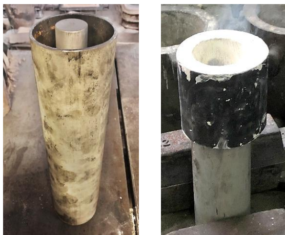
Obr. 80 Vtokový kůl připravený k zaformování (vlevo) a vtoková jamka, natřená zirkonovým nátěrem (vpravo).
