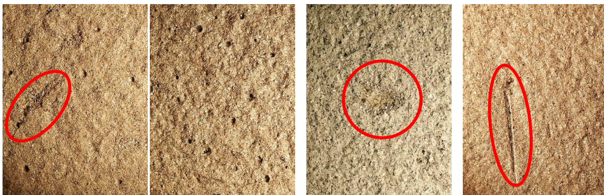
Obr. 92 Nátěr č. 1 - vlevo vada vzorku, vpravo bublinky.
