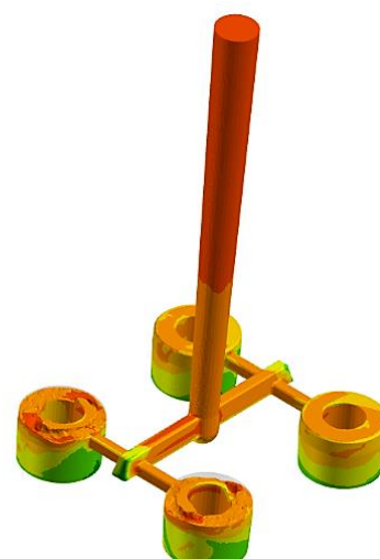
Obr. 60 Stav plnění odlitku v čase ~3,5 s od začátku lití.
