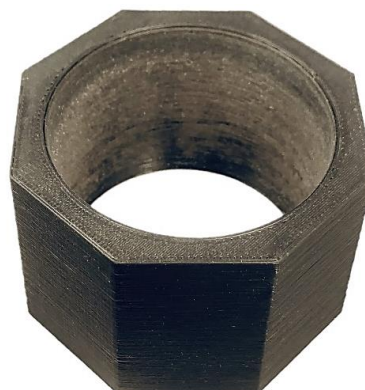
Obr. 64 Přípravek pro vybroušení úkosu spodní známky jádra.
