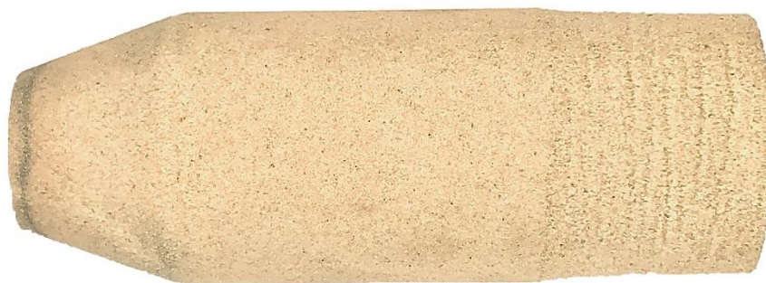
Obr. 67 Vyrobené zkušební jádro před aplikací nátěru.
