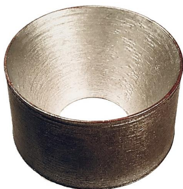
Obr. 63 Vložka do jaderníku pro odformování vrchní známky.
