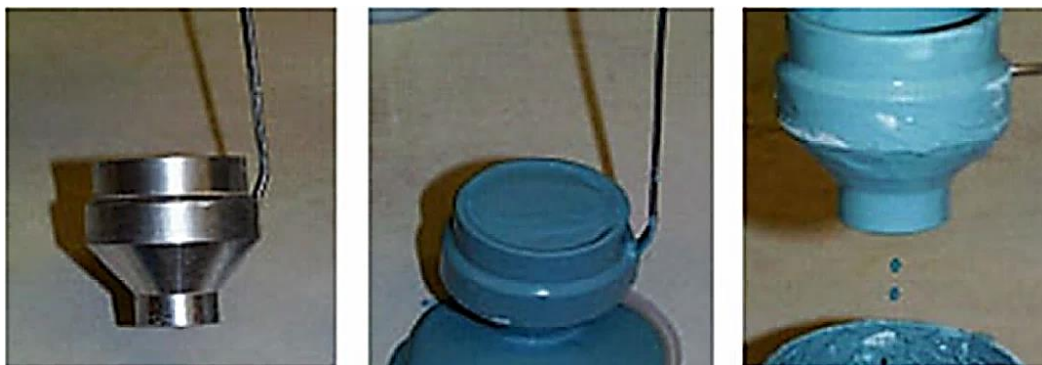
Obr. 35 Měření viskozity pomocí Fordova pohárku [32].
