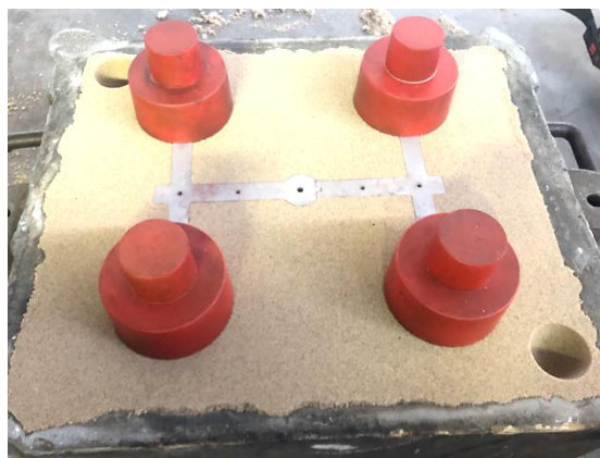
Obr. 77 Zaformování spodní poloviny formy (na obrázku chybí dopadová jamka).
