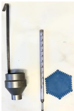
Obr. 83 Pomůcky použité při testování nátěrů. Zleva: Fordův pohárek, měřič Baumé a měřič tloušťky nátěru.
