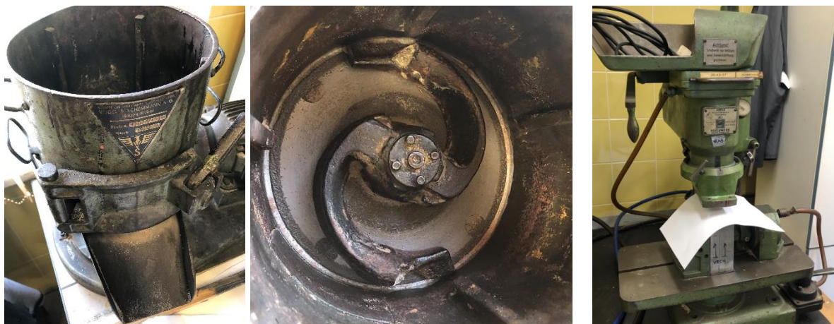
Obr. 65 Mísič používaný při experimentu. Vpravo vnitřní část mísiče s lopatkami.
