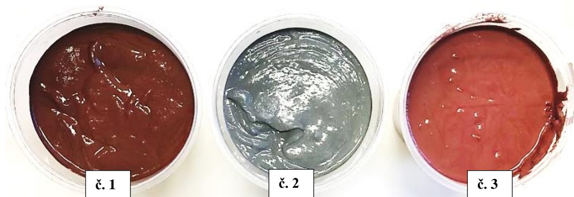
Obr. 43 Jednotlivé nátěrové koncentráty, zleva nátěr č. 1, č. 2 a č. 3.
