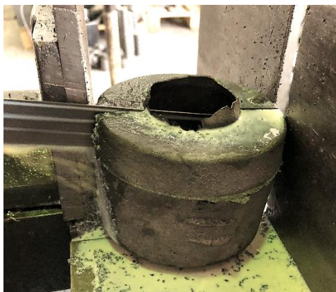
Obr. 97 Příprava vzorků – dělení odlitku.
