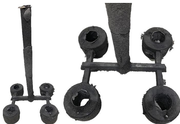
Obr. 96 Surový odlitek po vyjmutí z formy.
