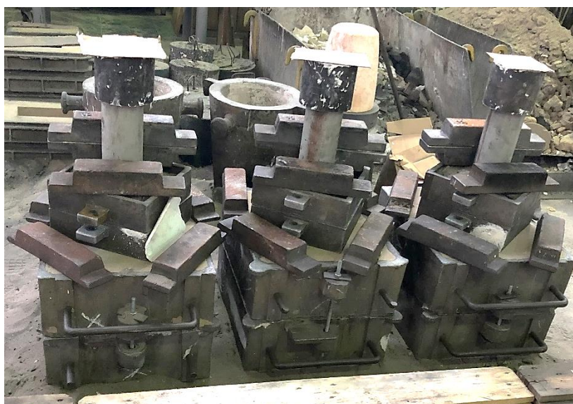
Obr. 82 Složené a zatížené formy, připravené na licím poli k odlití.
