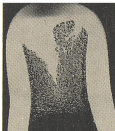
Obr. 6 Příklad hluboké zapečeniny jádra [15].
