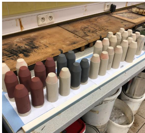
Obr. 84 Jádra v průběhu máčení.
