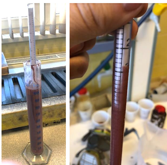
Obr. 85 Měření hodnoty Baumé.
