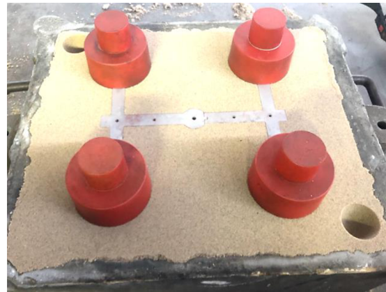
Obr. 77 Zaformování spodní poloviny formy (na obrázku chybí dopadová jamka).
