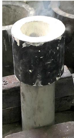
Obr. 80 Vtokový kůl připravený k zaformování (vlevo) a vtoková jamka, natřená zirkonovým nátěrem (vpravo).
