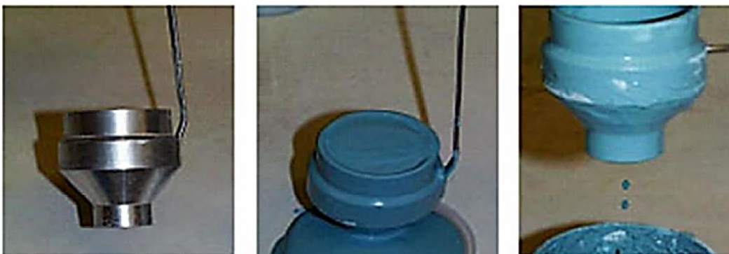
Obr. 35 Měření viskozity pomocí Fordova pohárku [32].
