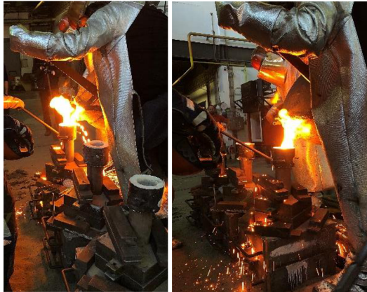
Obr. 95 Fotografie z průběhu lití.
