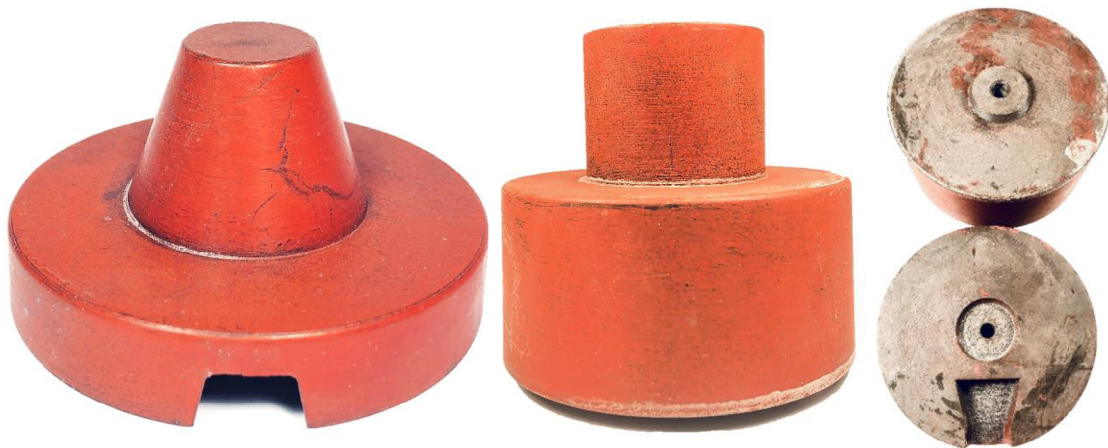
Obr. 72 Vytisknutá a natřená část modelu pro testovací odlitek. Vlevo vrchní a uprostřed spodní část modelu. Vpravo obě poloviny v pohledu zespod (spodní část nahoře).
