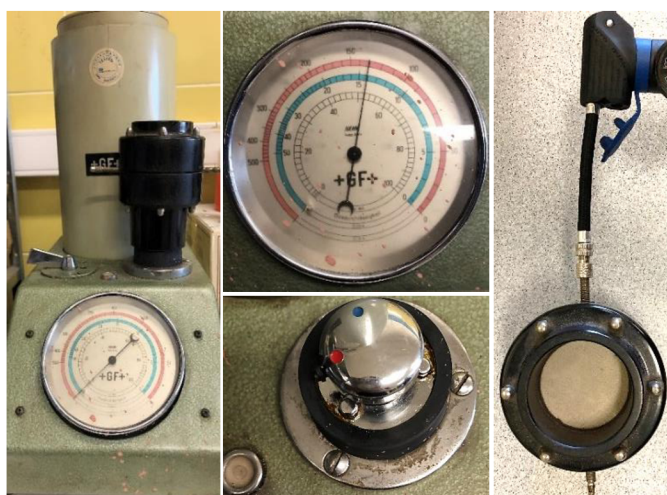
Obr. 88 Přístroj na měření prodyšnosti. Uprostřed nahoře stupnice prodyšnosti, dole přepínač průtočnosti. Vpravo přípravek na umístění vzorku.
