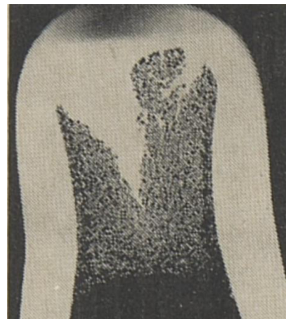
Obr. 6 Příklad hluboké zapečeniny jádra [15].
