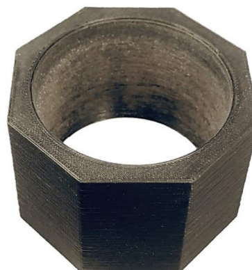
Obr. 64 Přípravek pro vybroušení úkosu spodní známky jádra.
