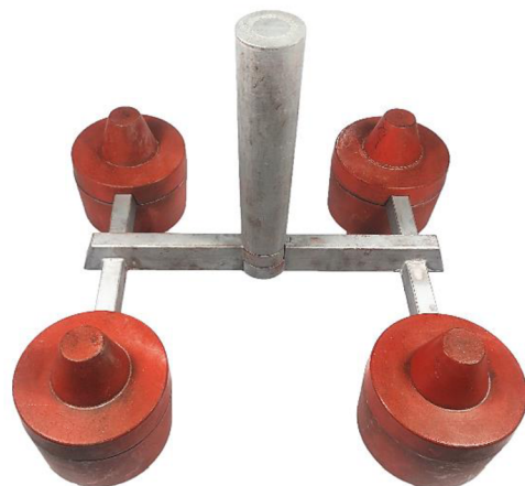
Obr. 74 Sestavená vtoková soustava s odlitky (bez dopadové jamky).
