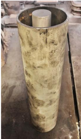
Obr. 80 Vtokový kůl připravený k zaformování (vlevo) a vtoková jamka, natřená zirkonovým nátěrem (vpravo).
