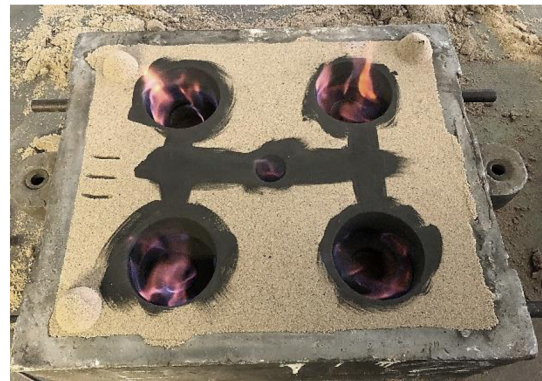
Obr. 79 Zapálený uhlíkatý nátěr.
