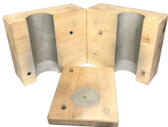
Obr. 61 Rozebraná dřevěná část jaderníku.
