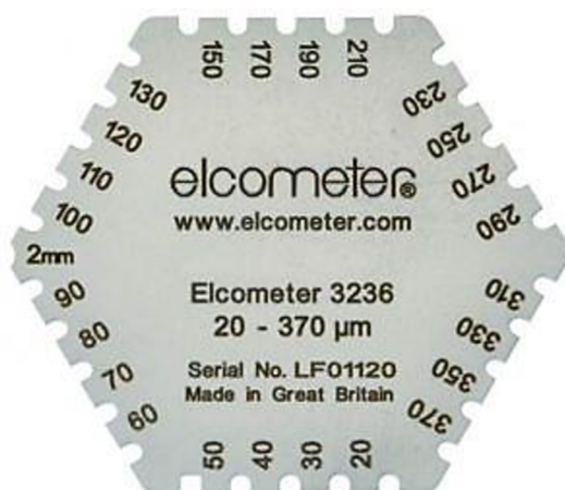
Obr. 36 „Hřeben“ na měření tloušťky vrstvy nátěru, stupnice v \mu\text{m} [38].
