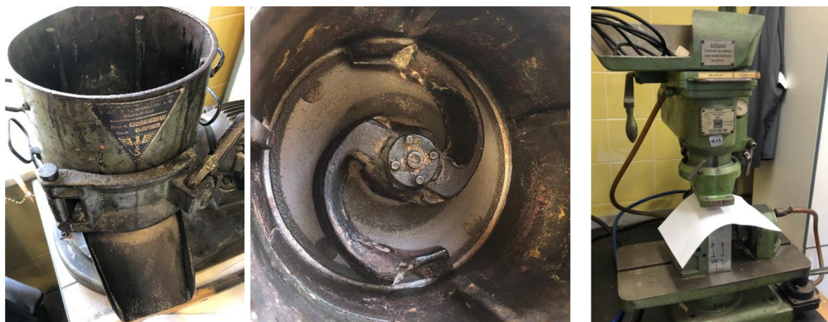
Obr. 65 Mísič použitý při experimentu. Vpravo vnitřní část mísiče s lopatkami.
