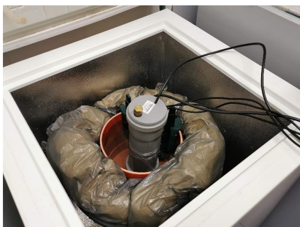
Obr. 52 Kapacitní sonda v pokusné tepelně izolované nádrži umístěné v mrazícím boxu
