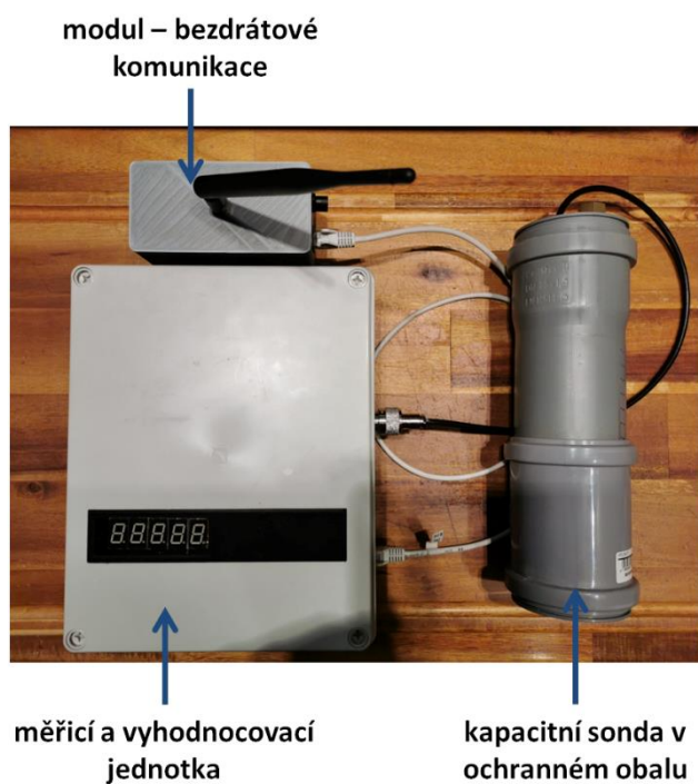
Obr. 44 Měřicí a vyhodnocovací jednotka s kapacitní sondou v ochranném obalu a modulem pro bezdrátovou komunikaci
