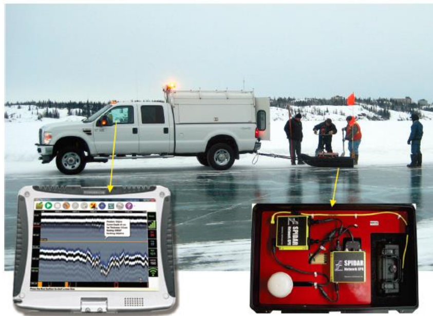
Obr. 5 Měřicí aparatura pro sledování mocnosti ledu na ledových cestách, na obrázku je uveden detail jak na samotnou GPR jednotku (pravý dolní roh), tak na monitor výsledků měření (levý dolní roh) [22]
