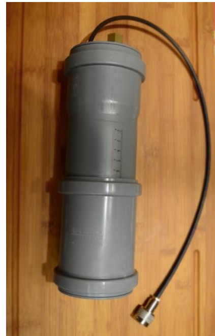
Obr. 33 Kapacitní sonda v ochranném izolačním obalu
