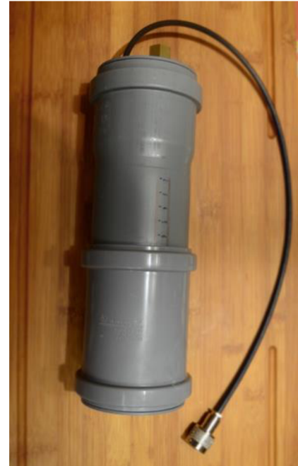
Obr. 33 Kapacitní sonda v ochranném izolačním obalu
