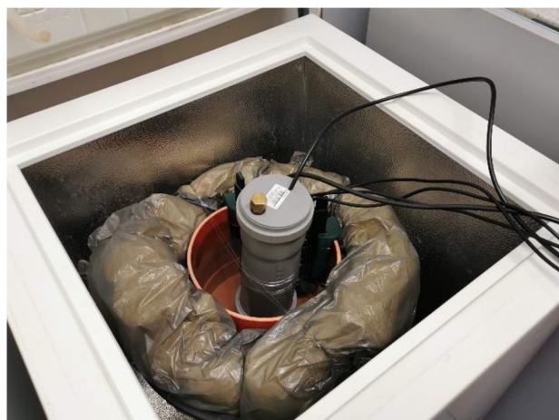
Obr. 52 Kapacitní sonda v pokusné tepelně izolované nádrži umístěné v mrazicím boxu
