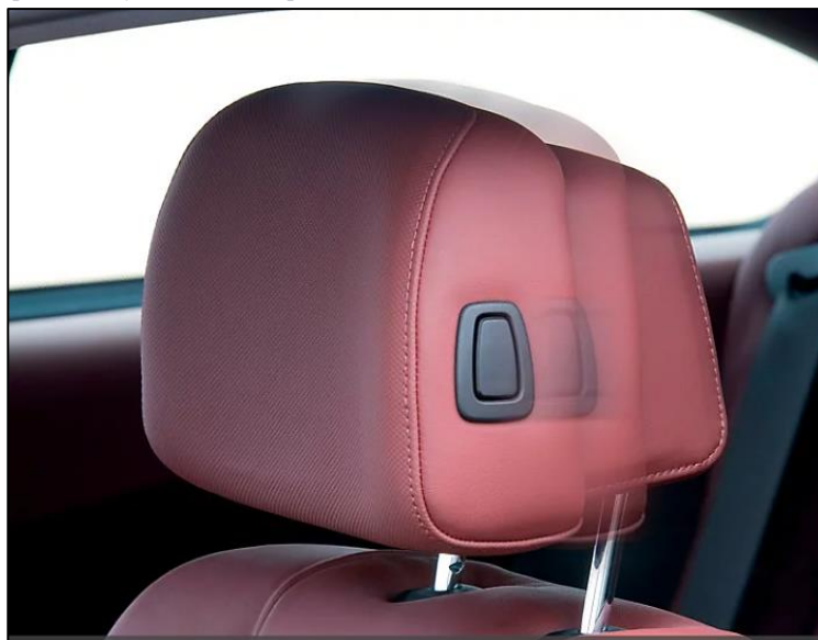
Obrázek 18 Aktivní opěrka hlavy automobilní společnosti BMW [62]
