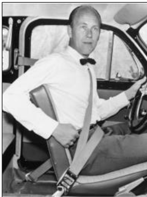
Obrázek 6 Tříbodový bezpečnostní pás s jeho vynálezcem Nilsem Bohlinem [21]
