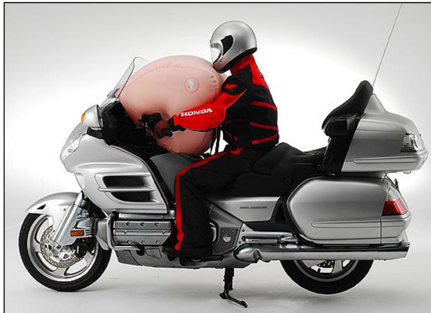
Obrázek 12 První airbag na motocyklu [38]
