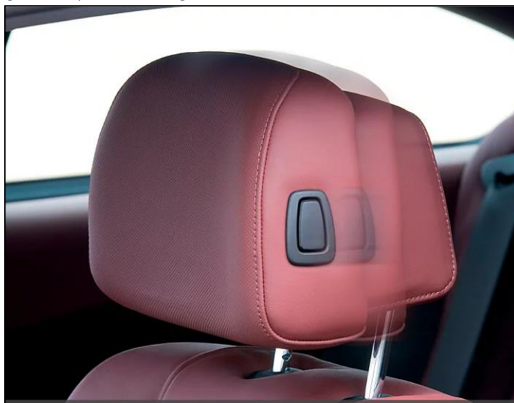
Obrázek 18 Aktivní opěrka hlavy automobilní společnosti BMW [62]
