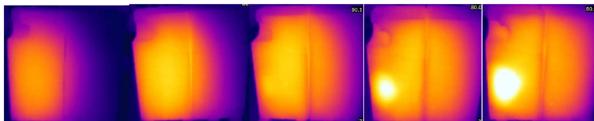
Obr. 4.13 – Termovizní snímky průřezu ve směru šíření vln, 1. – 5. cyklus chladnutí
