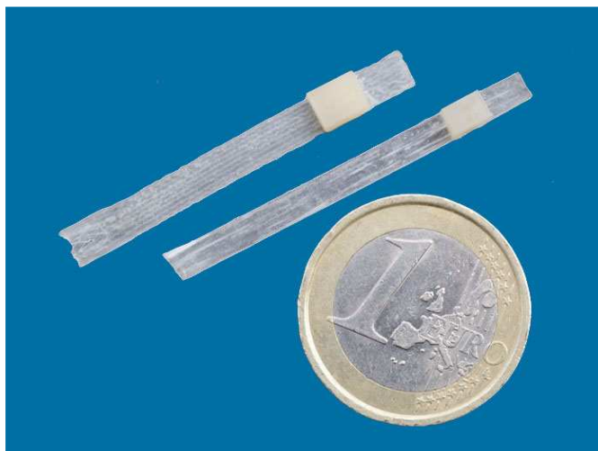
Obr. 23. Připravené vzorky s dvěma různými typy FRC pro srovnání velikostí s 1 € mincí.
