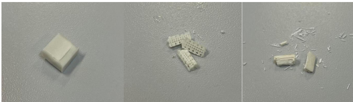
Obrázek 34 Tělesa ze směsi RP15 po tlakové zkoušce; vlevo- po měsíci biodegradace; uprostřed- po 4 měsících biodegradace; vpravo- po 5 měsících biodegradace
