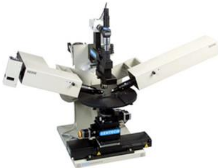
Obr. č. 25 Spektroskopický elipsometr SENTECH SE 850
