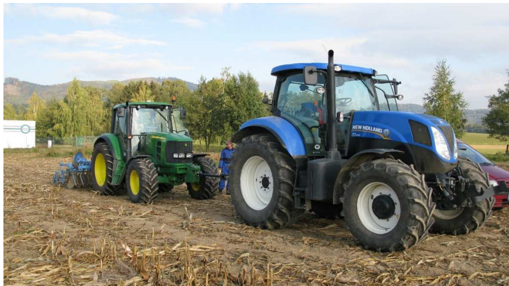
Obr. 16 – Souprava při měření tahového odporu
