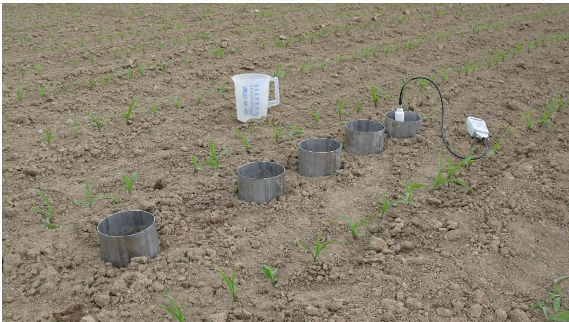
Obr. 15 – Měření infiltrační schopnosti půdy
