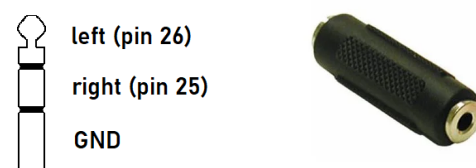
Obrázek 4.13: Schéma připojení pinů ESP32 na audio kabel s konektorem JACK [M] a spojka pro jeho propojení s adaptérem na konektor DIN 5-pin [45]
