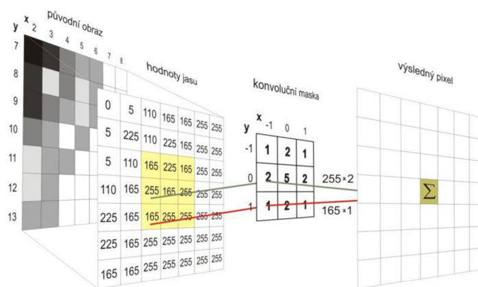
Obrázek 2.2 - Princip diskrétní konvoluce [15]
