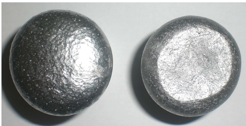
Obr.: 4.3 Vzorky pro měření naplynění, vpravo je vidět vzorek ztuhlý za atmosférického tlaku, vlevo za podtlaku.
