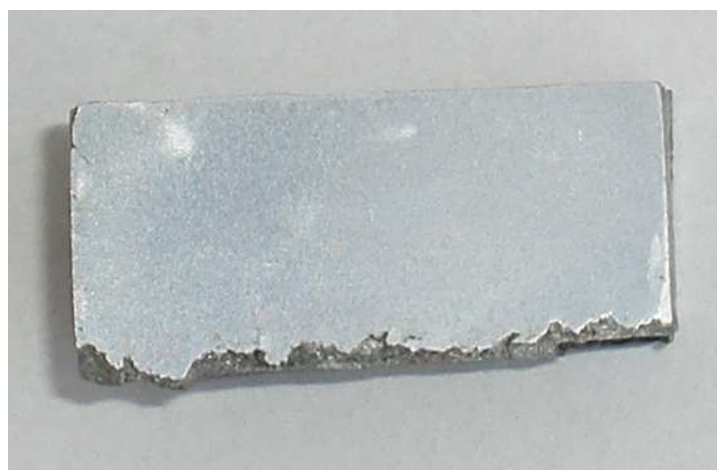
Obr.:6.11 Makrostruktura odlitku 4-2, bez porezity
