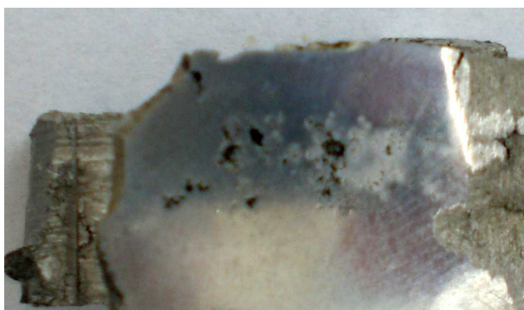
Obr.:6.7 Makrostruktura odlitku 4-2, s výraznou perezitou
