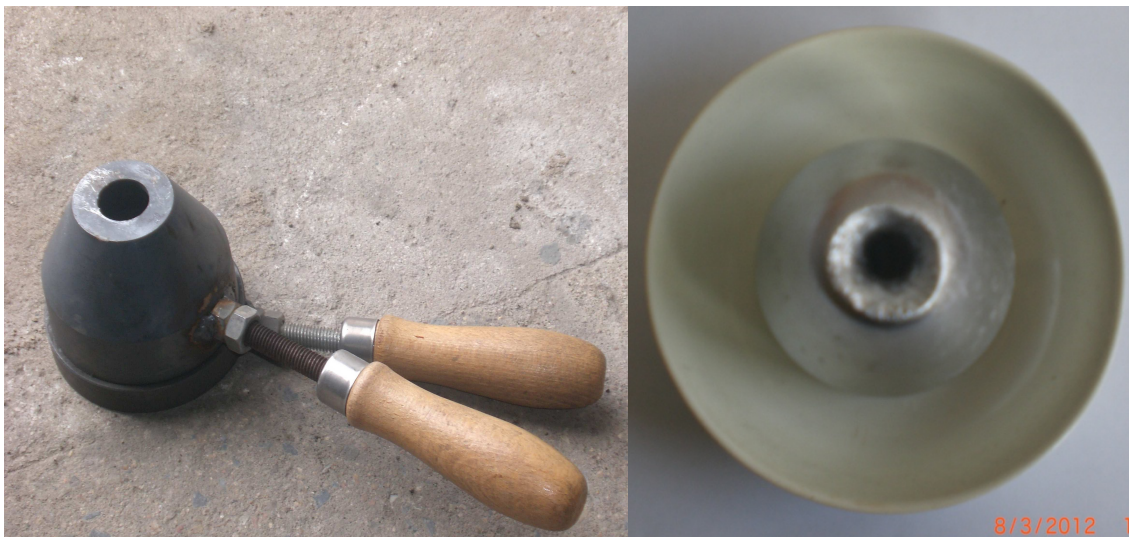
Obr.: 4.8 Taturova zkouška stahování [2]
