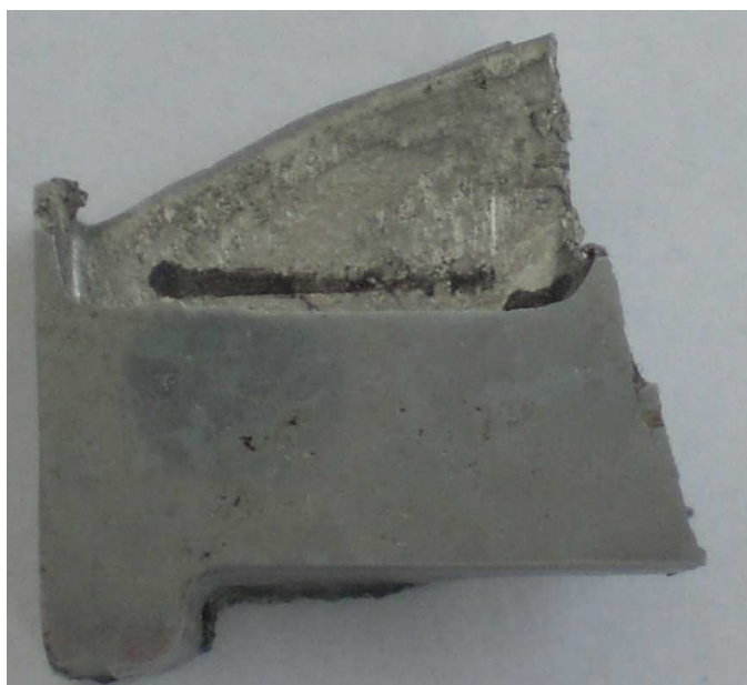
Obr.:6.9 Makrostruktura odlitku 4-1, s porezitou
