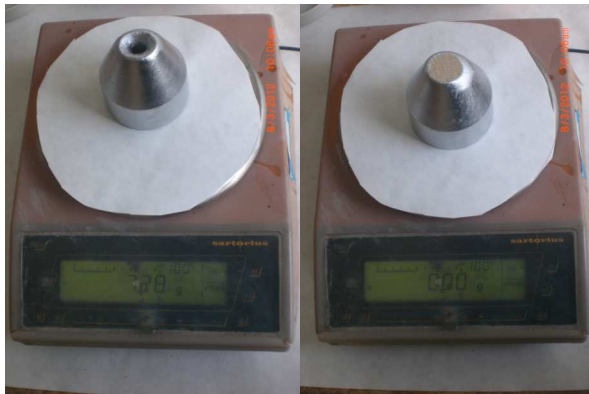
Obr.: 4.12 Zjišťování objemu staženiny
