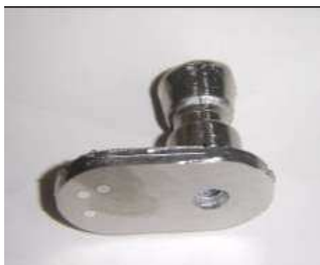
Obr.:4.2 Odlitý vzorek k určení chemického složení [10]
