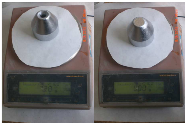
Obr.: 4.12 Zjišťování objemu staženiny
