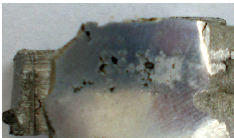
Obr.:6.7 Makrostruktura odlitku 4-2, s výraznou perezitou
