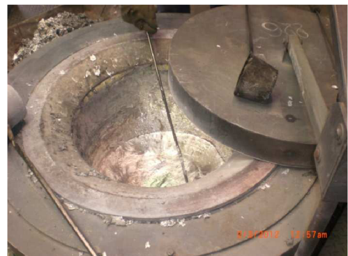
Obr.: 4.20 Elektrická odporová udržovací pec 2
