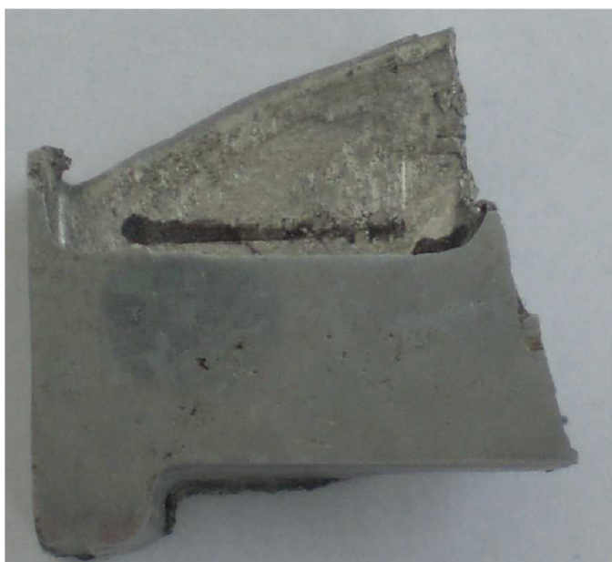
Obr.:6.9 Makrostruktura odlitku 4-1, s porezitou
