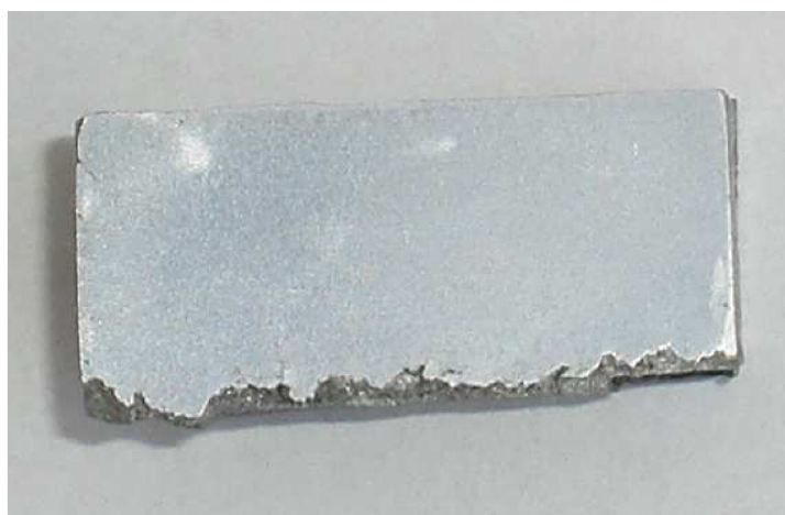
Obr.:6.11 Makrostruktura odlitku 4-2, bez porezity
