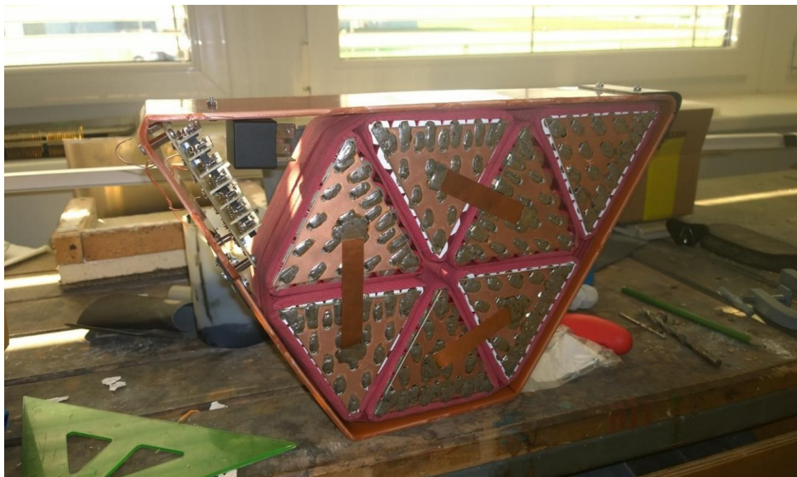
Obrázek 9: Akumulátor před zapojením BMS obvodu
