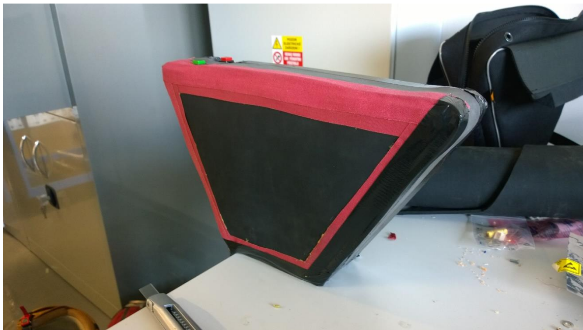
Obrázek 12: Obložení akumulátoru mikroporézní pryží
