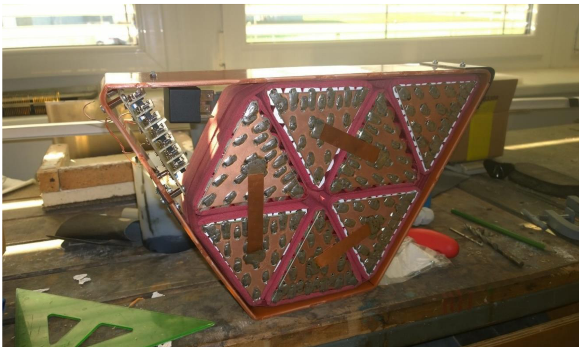
Obrázek 9: Akumulátor před zapojením BMS obvodu
