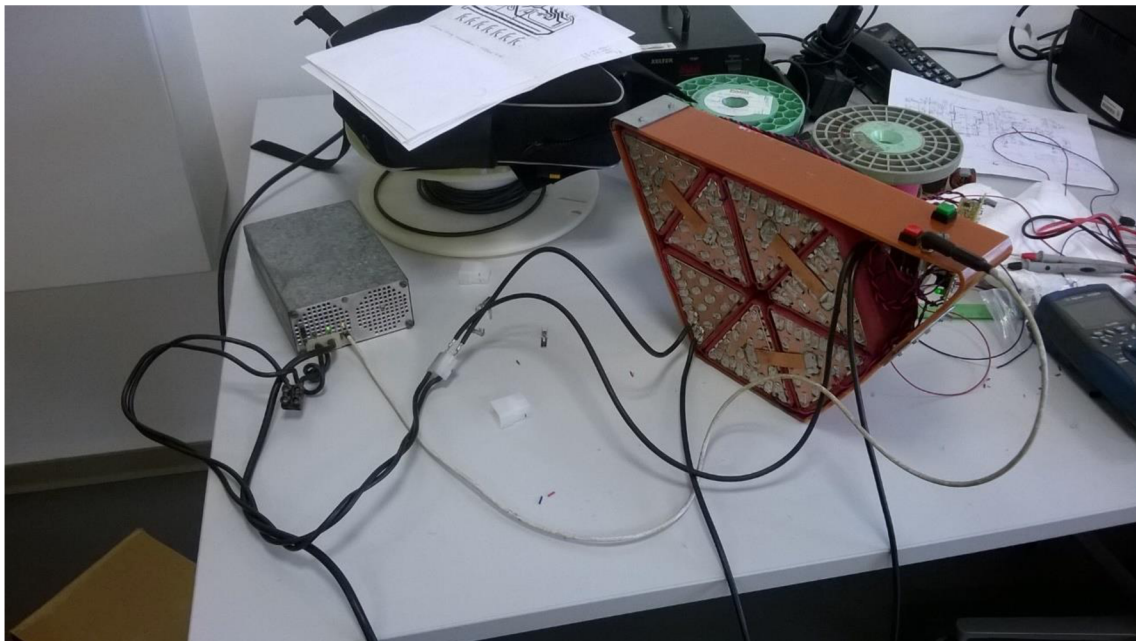
Obrázek 14: Nabíjení akumulátoru (u červeného tlačítka pro odpojení akumulátoru můžeme vidět vodič s koncovkou 3,5 jack, který se stará o zpětnou vazbu od BMS k nabíječce)
