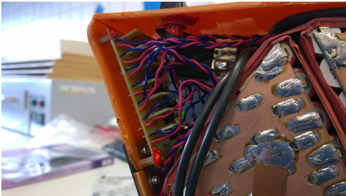
Obrázek 10: Připojení sériových článků k ochrannému obvodu
