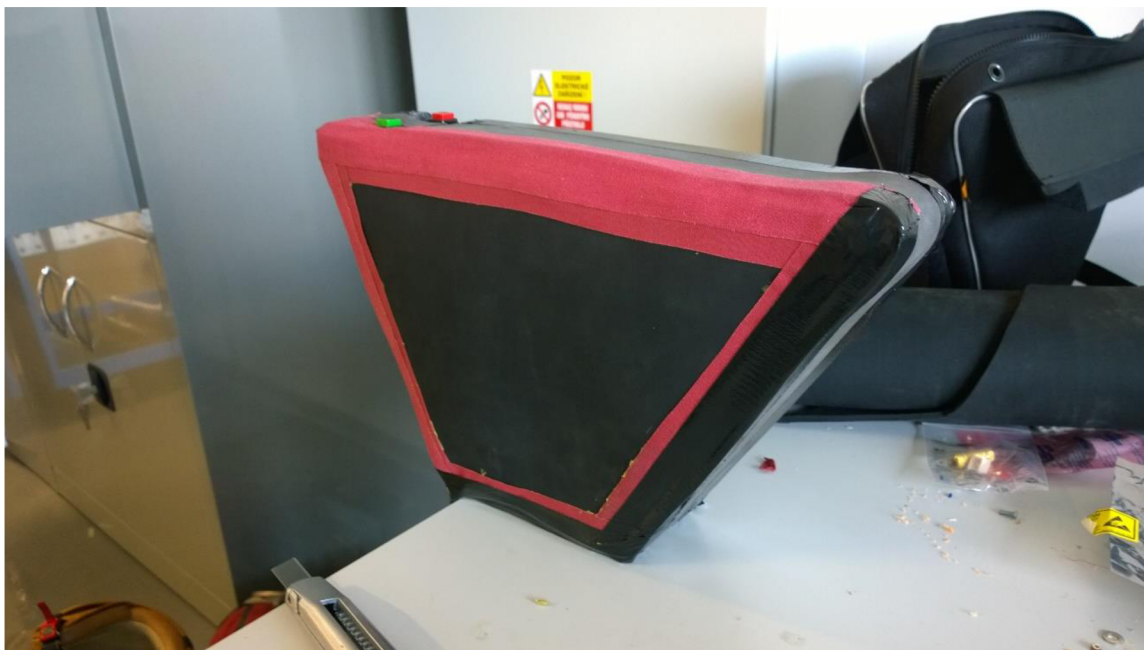
Obrázek 12: Obložení akumulátoru mikroporézní pryží
